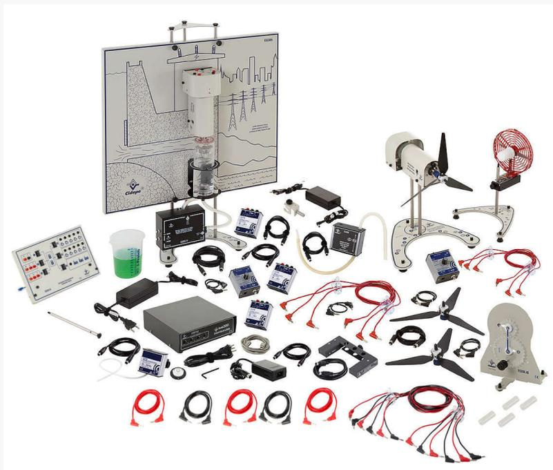
Conjunto energias renováveis, hidroelétrica, aerogerador, consumidor, com interface e sensores
