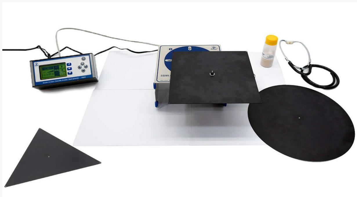
Conjunto de três placas de Chladni, vibrações, com gerador de sinais de áudio
