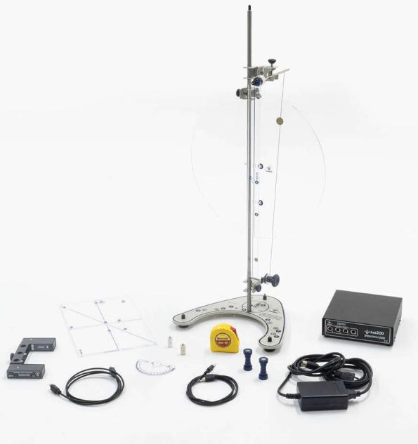
Conjunto de pêndulo simples e pêndulos físicos, pivô rolamentado, com sensor e interface.
