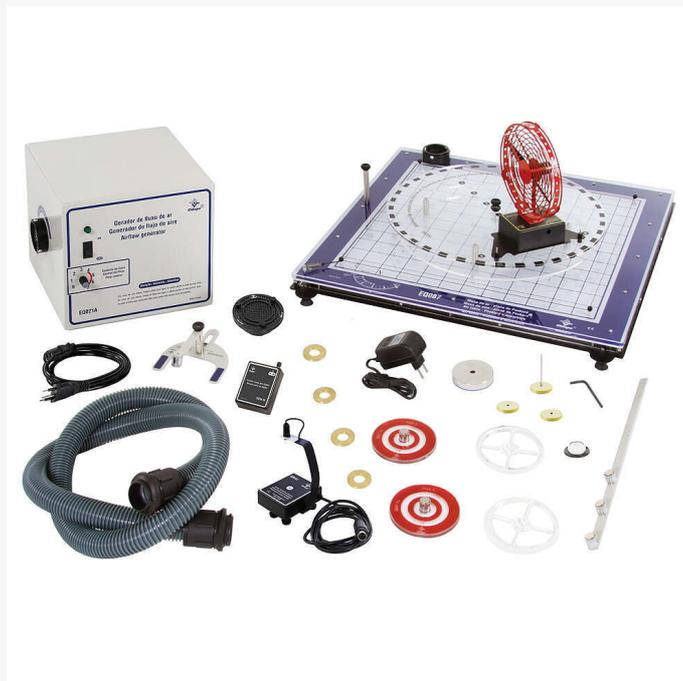
Mesa de aire (Plan Packard) con sensor y conjunto dinâmica de rotación.
