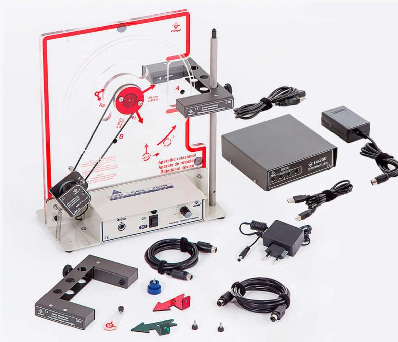
Dispositivo rotacional diseñable con flechas, interfaz y sensores.
