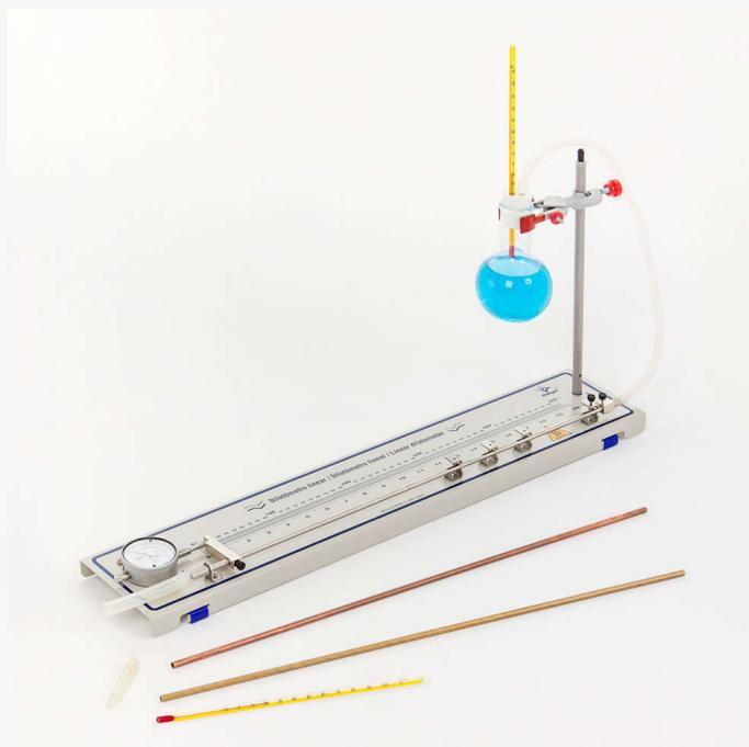
Dilatómetro lineal con matraz y termómetro de columna líquida.
