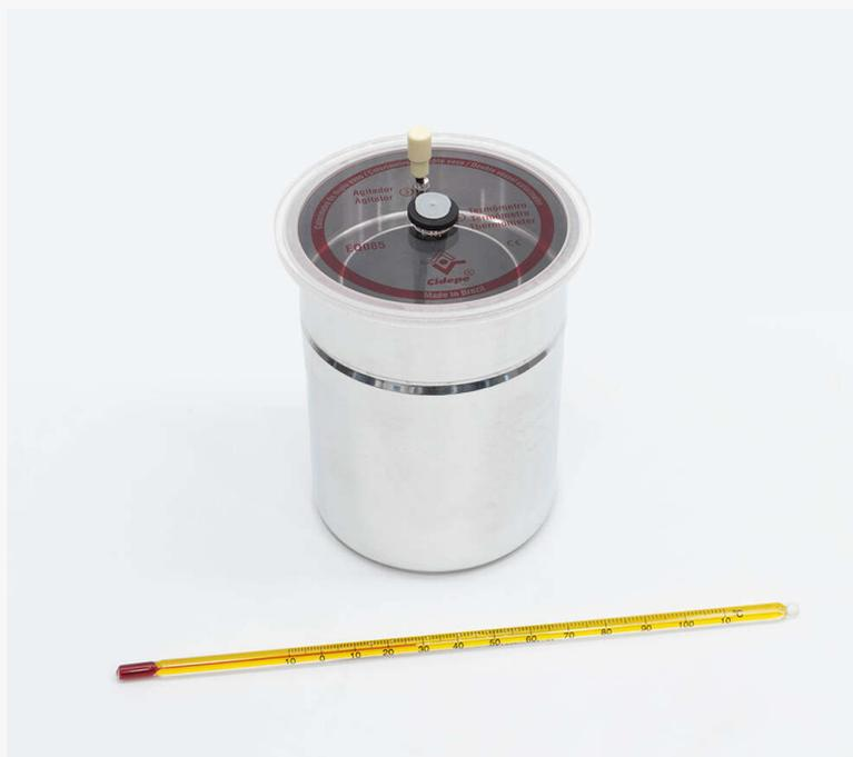
calorímetro de agua con doble vaso de aluminio, 250 ml, aluminio y termómetro con columna líquida de -10 a +110 °C
